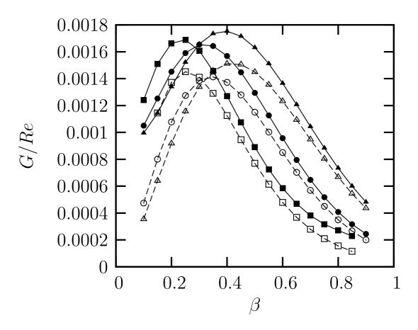
Objective function G/Re: effect of  $\beta$ ,  $T_w/T_{\rm ad}$  and norm choice (PEN vs. FEN) for M=3,  $Re=10^3$ ,  $x_{\rm in}=0$   $x_{\rm out}=1.0$ .  $\Box$ ,  $T_w/T_{\rm ad}=1.00$ ;  $\bigcirc$ ,  $T_w/T_{\rm ad}=0.50$ ;  $\triangle$ ,  $T_w/T_{\rm ad}=0.25$ .  $\Rightarrow$  Up to 17% difference for low values of  $\beta$ .
